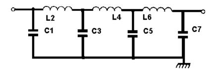
W3NQN 7 ELEMENT STANDARD VALUE CAPACITOR LOW PASS FILTERS
