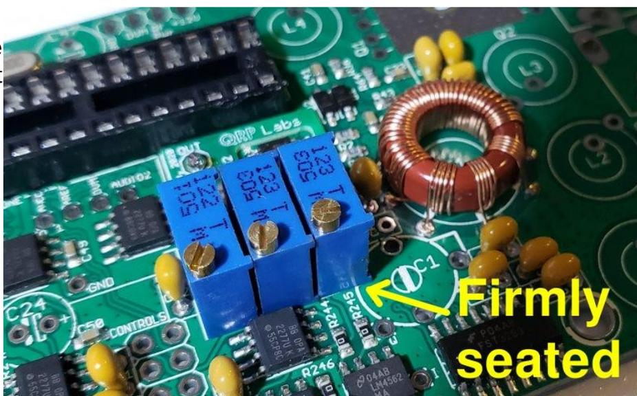
Les vis de la résistance doivent correspondre aux vis de la sérigraphie du circuit imprimé et du schéma de montage.
