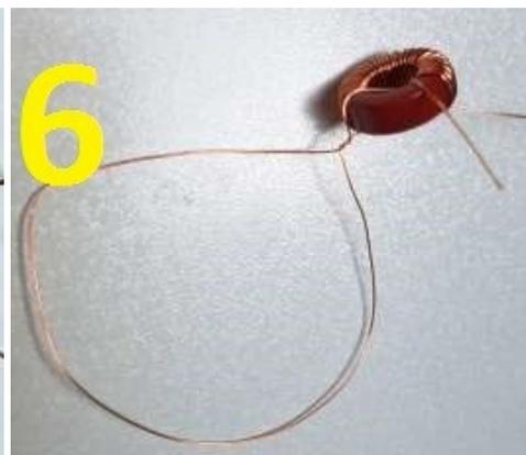
7) 同じことをあと2つの輪について行います。43巻き目と44巻き目の間、48巻き目と49巻き目の間です。巻き数のカウントは忘れやすいです。手順6以後の簡便法は、輪にワイヤを5回多く通します。そして5回目で長い輪を作ります。同様に5回多く数え、5回目で長い輪を作ります。これで、最後に5回多く巻いてトロイドの53回巻き線が完成です。巻き線を数えて53巻きになっていることを確認します。すべてOKなら末端に3cmを残してワイヤをカットします。
