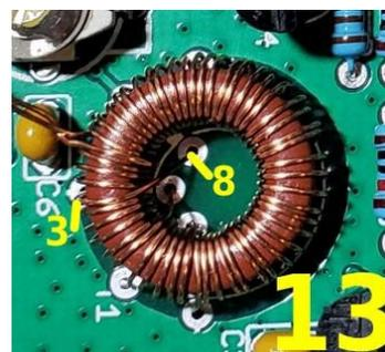
13) ステップ 11 と同様：トロイドの上側から5本巻きのワイヤ端（他の端はステップ 11 で hole 4 に入っている）が来ていますので、これを hole 3 に挿入します。 もう1本のワイヤ端がトロイドの下側から来ているのでトロイド側に押し込み、中央穴から下に引き出します。 これは hole 8 に挿入します。 今、基板上の hole 3 と hole 4 の間に“Primary”の5回巻き線がある筈です。
