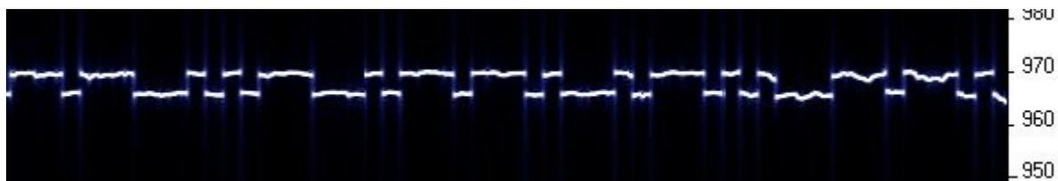
Ovviamente il modulo DDS è stato progettato per altre applicazioni e non per il nostro kit QRSS, per cui la stabilità a livello di pochi Hertz non era importante. Io credo che ci sono componenti sensibili alla temperatura
