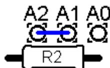
2) Luminosità ridotta: Se operate tramite una batteria e desiderate aumentarne l'autonomia oppure se la massima luminosità dello schermo LCD non è di vostro gradimento, ponticellate i punti "A1" e "A2" e utilizzate un resistore di valore opportuno nella posizione R2 (circa 100 Ohm).
