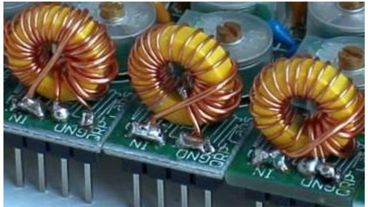
**Ne pas souder l'extrémité «chaude» des enroulements toroïdaux principaux! Ceci sera fait temporairement avant l'installation dans le trou du circuit imprimé - voir l'étape "Réglage" ci-dessous.**
