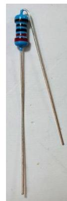
La posizione di questi resistori è rappresentata in verde sul diagramma qui sotto. A livello circuitale non importa come volete installarli, ma credo che la scheda sembri più ordinata se sono inseriti tutti allo stesso modo, ad esempio tutti con il corpo a sinistra e il reoforo sulla destra, o tutti viceversa.
