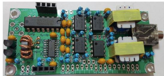
Essayez d'adapter le tore le plus à gauche possible, comme sur cette photo, afin qu'il n'interfère pas avec le module de filtre passe-bande une fois branché.
