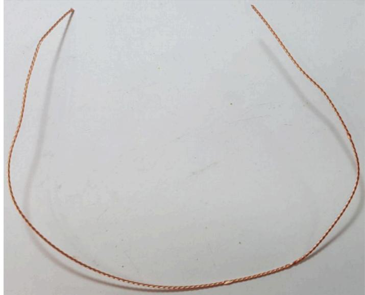
Maintenant, coupez les extrémités désordonnées et c'est le fil qui servira à enrouler le noyau toroïdal FT37-43 en transformateur tri filaire.
