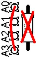
c) **輝度をソフトウェアで制御する設定:** U3は"Backlight"の設定でバックライトの明るさを制御できます。(0でバックライトオフ 9で最大輝度) バックライトの明るさはPWMで制御しています。A0とA3をジャンパー線で接続するとこの設定になります。(この時R2は実装しないでください。)
